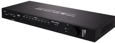
本型號 9 x 2 的多重格式縮放切換器提供了 HDMI、USB Type C、HDBaseT 和 VGA 輸入，可以根據使用者選擇的縮放解析度自由選擇，以輸出鏡像的 HDMI 以及 HDBaseT 輸出。HDMI 和 USB-C 端口支援 4K@60(4:4:4、8-bit) 解析度，而 HDBaseT 輸出支援 4K60(4:4:4) 訊號源自動降轉至 4K60(4:2:0)。VGA 輸入支援高達 WUXGA 解析度。HDBaseT 輸出提供絕佳解決方案，可透過單一的 Cat.5e/6/7 纜線，將音訊和影像傳輸距離延長至 70 公尺 (4K)，並為相容的 HDBaseT 接收器提供 48V PoH 電源。
