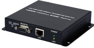
HDMI 轉單一 CAT5e/6/7 傳送器，能透過單一 CAT5e/6/7 傳輸線以不超過 100 公尺的距離，傳送未壓縮的音訊 / 影像以及 IP 數據。另外產品更內建了 RS-232 和 IR 端口，還有雙向 LAN 伺服連接。接收器 (PSE) 可供電 48V PoE 至發送器 (PD)，提高產品安裝的靈活性。
